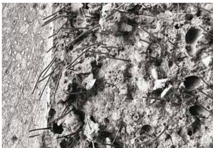
1. L'analisi della distribuzione e dei processi di rottura, snervamento e sfilamento delle fibre
